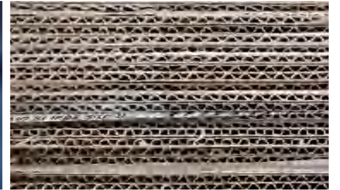
由回收纸板制成的纤维素基绝缘材料
